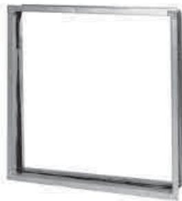
Соединительные фланцы предназначаются для крепления к вентиляционному агрегату воздуховодов. Со стороны всасывающего/нагнетательного отверстия агрегата фланец крепится с помощью болтов, а со стороны воздуховода - посредством гибкой вставки профиля LS.
