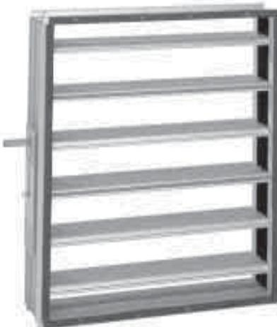
Многостворчатые клапаны устанавливаются в различных секциях агрегата DanX с целью балансирования воздушных потоков или в качестве отсекающей заслонки. Многостворчатый клапан представляет собой сборную конструкцию из алюминиевых выпрессовок, пластмассовых шестерен и подшипников и отвечает по стандарту EN 1886 классу 3 коррозийной стойкости и классу 4 воздухонепроницаемости. Таким образом, клапаны вполне подходят для применения в условиях агрессивной воздушной среды.
