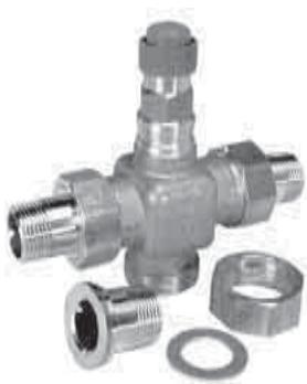
В зависимости от емкости воды калориферы могут комплектоваться 2-х или 3-х ходовыми регулирующими вентилями, в качестве исполнительного механизма которых используется электропривод модулирующего типа с управляющим сигналом от 0 до 10 В.
