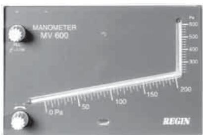
Дифманометры с наклонной шкалой устанавливаются снаружи агрегата и позволяют считывать действующее значение падения давления воздушного потока в каком-либо компоненте агрегата, например, в фильтре.
